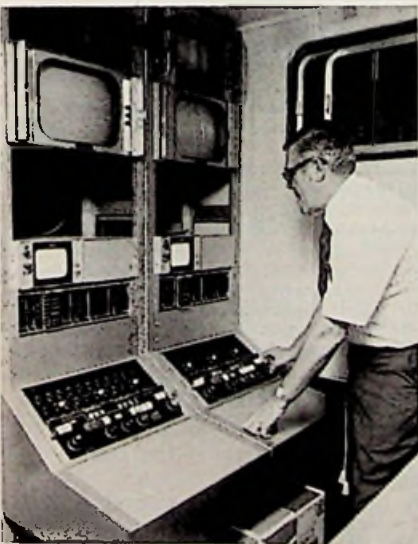
Gene Gery van RCA's vestiging in Pennsauken (N.J., VS.) voert de afleveringstest uit op een TV-camera-controle-eenheid voor de TV-reportagewagens die aan Radio Television Algerian zullen worden geleverd. RCA Broadcast Systems levert twee reportagewagens aan deze TV-omroeporganisatie.
